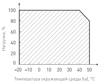
Рис. 2. Максимальная допустимая нагрузка, % от мощности источника
