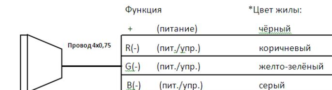
Схема подключения монохромного светильника
