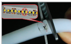
Перемещая ножницы левее или правее, найдите специальное место разреза на плате. Разрежьте ленту строго по обозначенной линии
